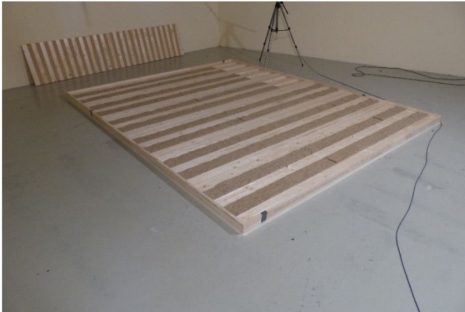
Bild 1: Rahmen mit Unterkonstruktion und Dämmung
