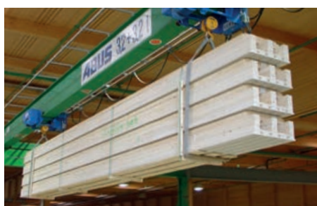
Éléments caisson BV aboutés
