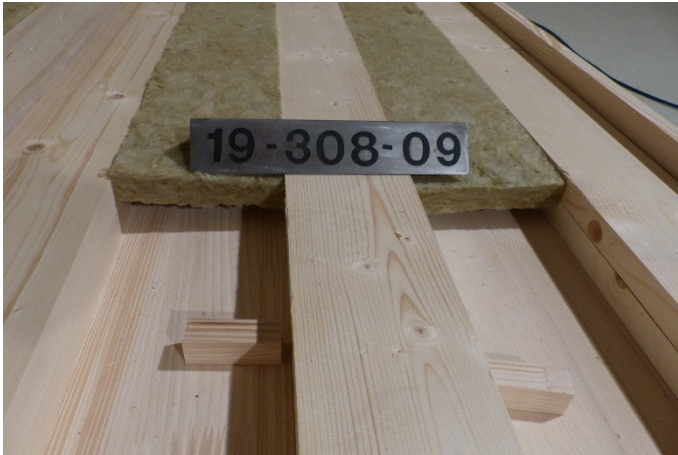
Bild 1: Rahmen mit Unterkonstruktion und Dämmung, Teilansicht
