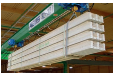
Fertig abgebundene BV-Kastenelemente
