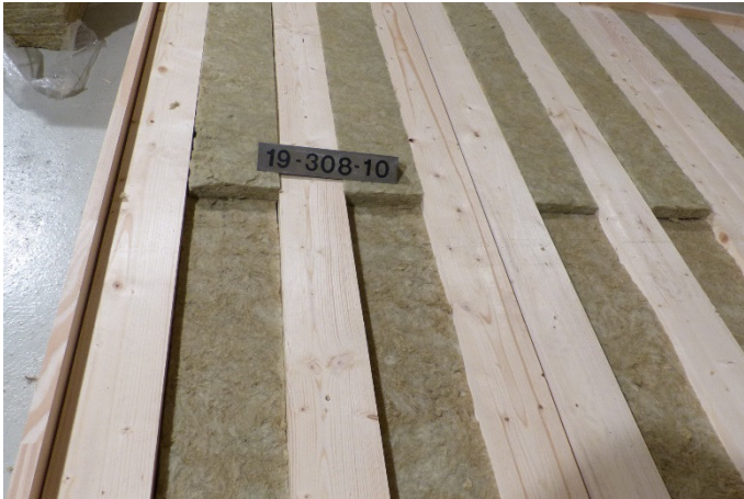
Bild 1: Rahmen mit Unterkonstruktion und Dämmung, Teilansicht
