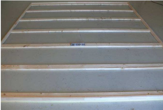
Bild 1: Rahmenkonstruktion ohne zusätzliche Bedämpfung
