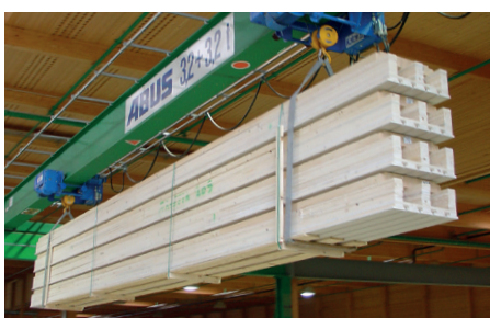
Fertig abgebundene BV-Kastenelemente
