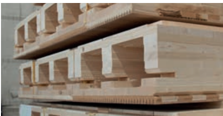
Ausarbeitung für Auflage auf Stahlprofil
