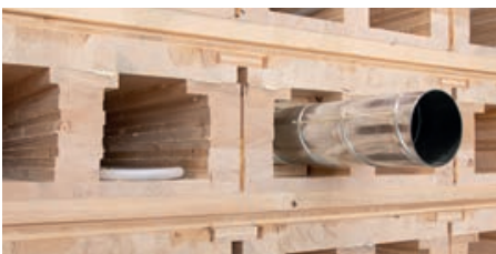
Werkseitige Installation von Lüftungsrohren (Wickelfalz) in BV-Elemente
