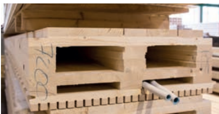
Werkseitige Installation von Leerrohren auf Ebene einer Pluslage _p26
