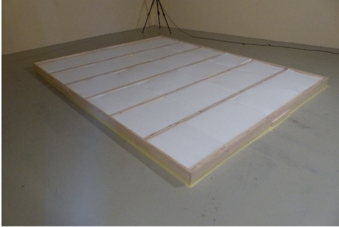
Bild 1: Rahmen mit Tragkonstruktion und Bedämpfung
